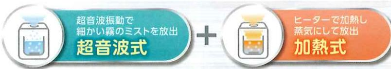
ヒーターで高温加熱した水を、超音波の振動で温かいミストにして噴霧させるので、大変衛生的です。
