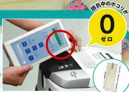
※パーティクルカウンターとは空気1ℓ中の0.3ミクロンのホコリの数を測定する精密機器です。(1ミクロン=0.001mm)
