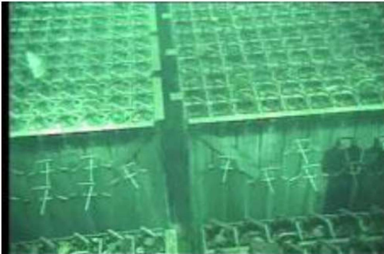
コンクリートポンプ車により使用済燃料プールから採取した水の核種分析から、燃料棒の著しい損傷は起こらなかったとみられる。
