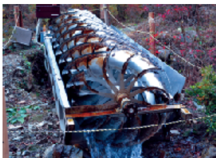
町田さん製作の発電装置は直径1m、らせん状のステンレス製の羽根10枚を回転させて発電します
