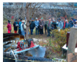
町田さん製作の発電装置は直径1m、らせん状のステンレス製の羽根10枚を回転させて発電します
